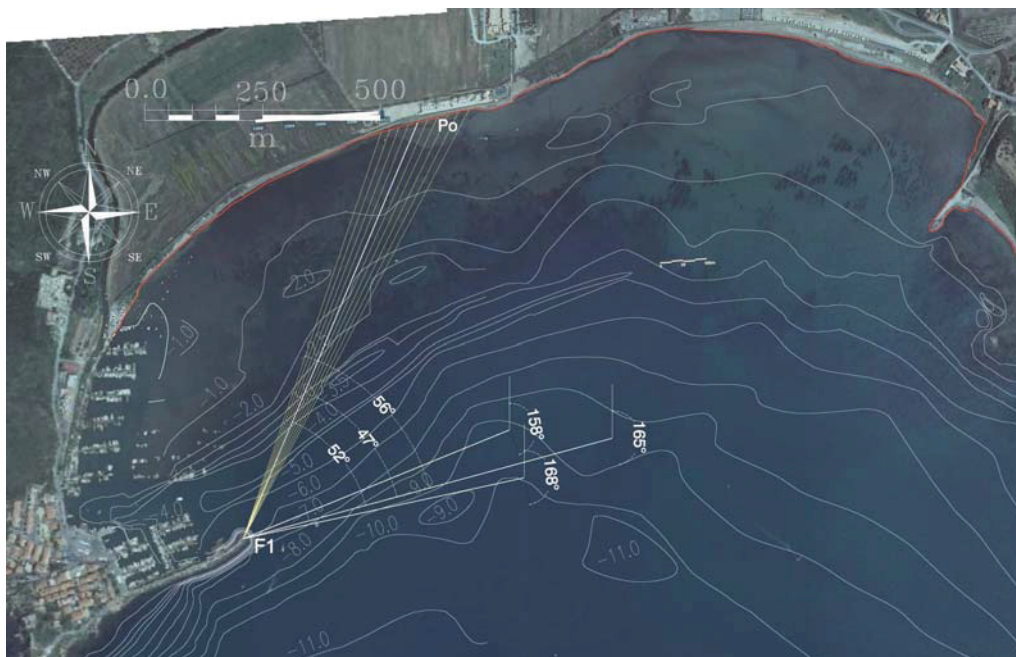
Figura 14 – Valori di SQRT per diversi angoli \beta per le onde incidenti di 165°N
